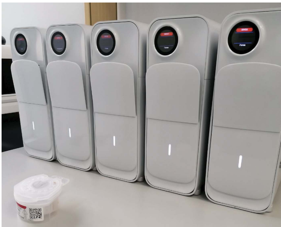
Рисунок 2. Опытная серия анализаторов (5 шт.) и одноразовый картридж с реагентами для проведения идентификации МБТ и выявления мутаций, обеспечивающих устойчивость возбудителя к рифампицину
