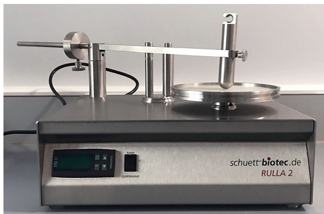
Рисунок 4. Испытательная установка Rulla 2 производства Schuett-biotec GmbH, Германия
